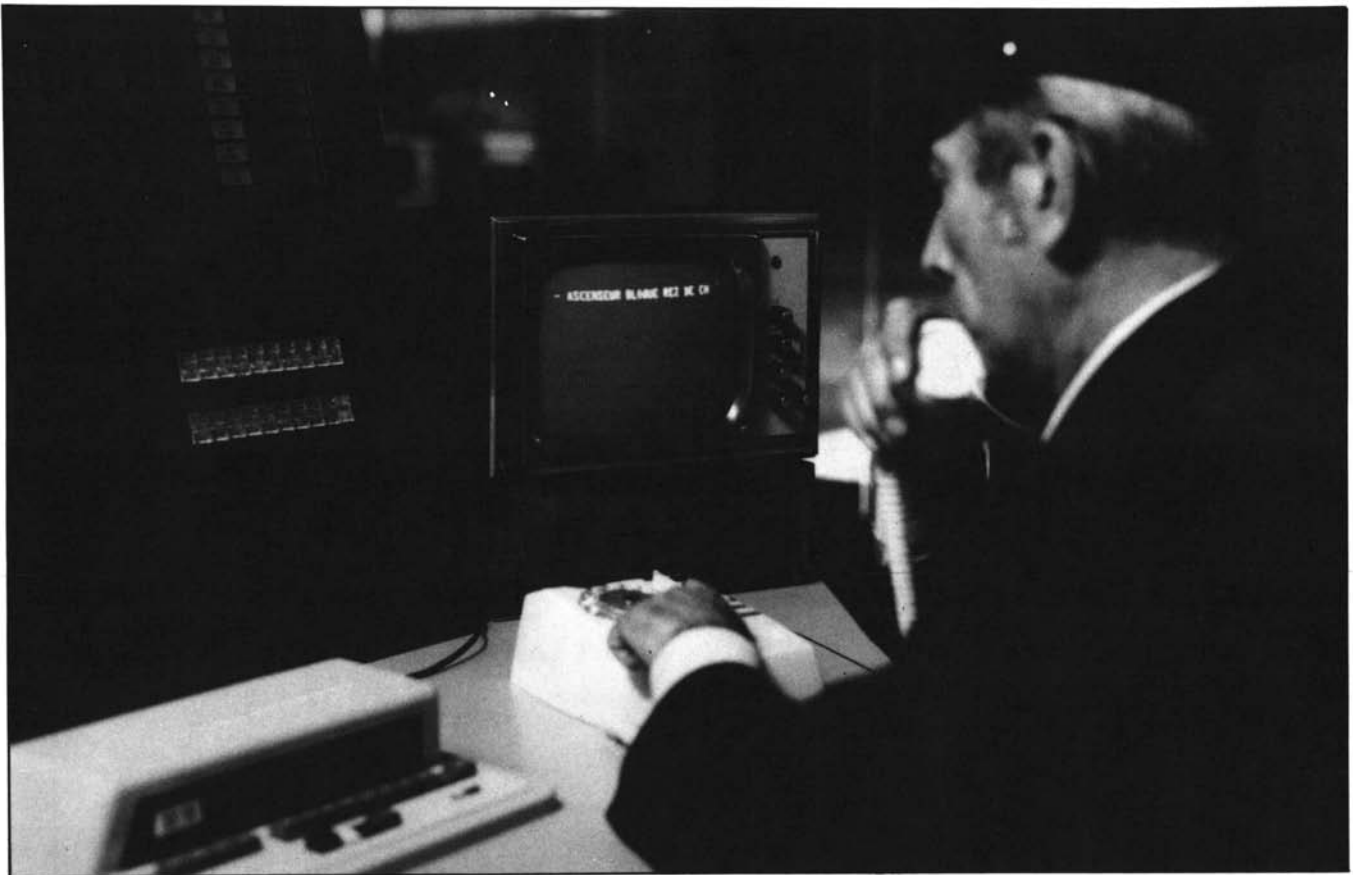
Clavier numérique 3221 et unité de contrôle d'affichage 5967. (Surveillance d'immeuble). Cliché IBM
