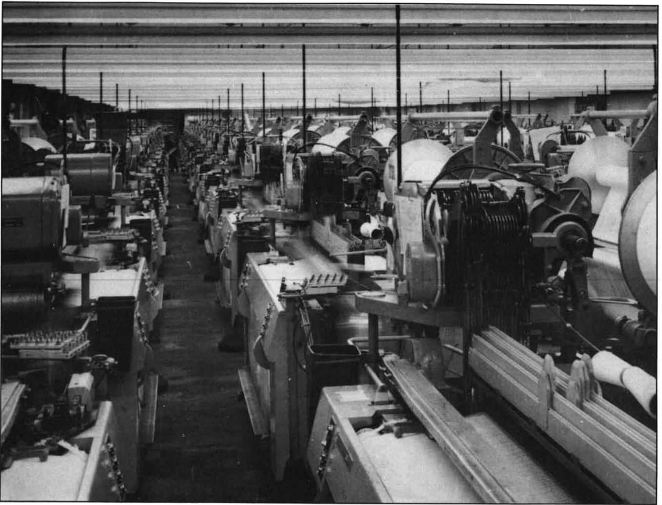
▲ Salle de machines à tisser à aiguilles volantes MAV. Société alsacienne de constructions mécaniques de Mulhouse.
