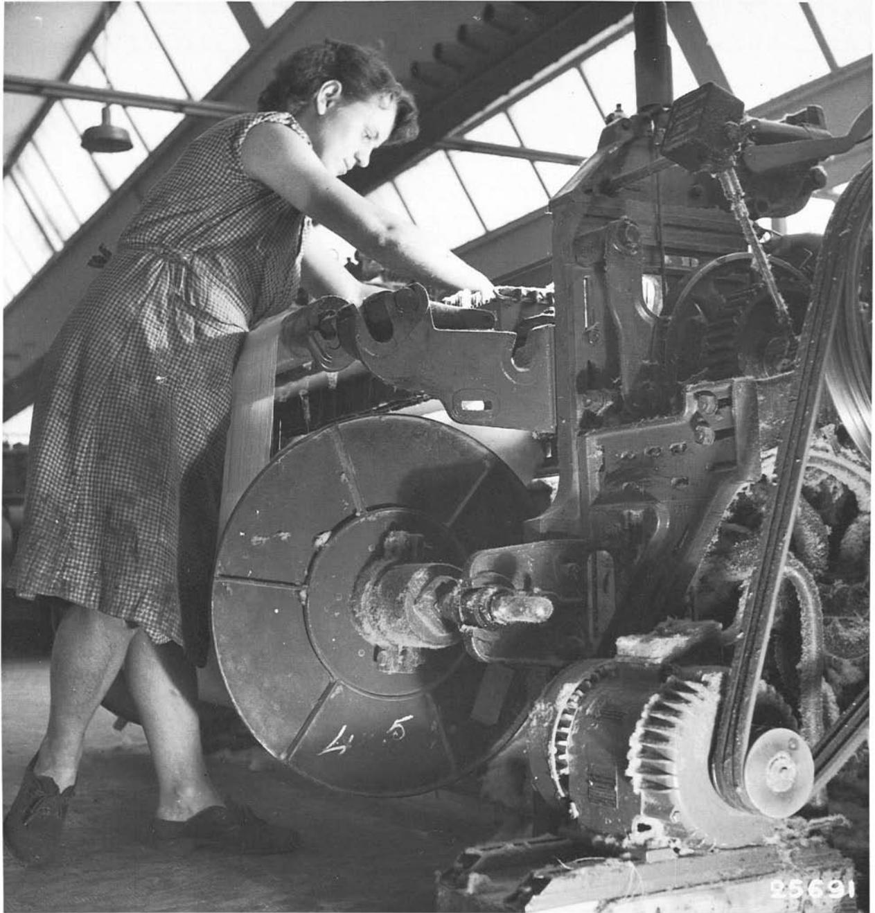
Fig. 14 Roue et pignons en prise au cours du contrôle du taillage à l'établissement Le Bourget, spécialisé dans les opérations d'étirage, de tréfilage et de guidage. On y façonne les ailettes de turbine et les fils de bobinage (1954).
