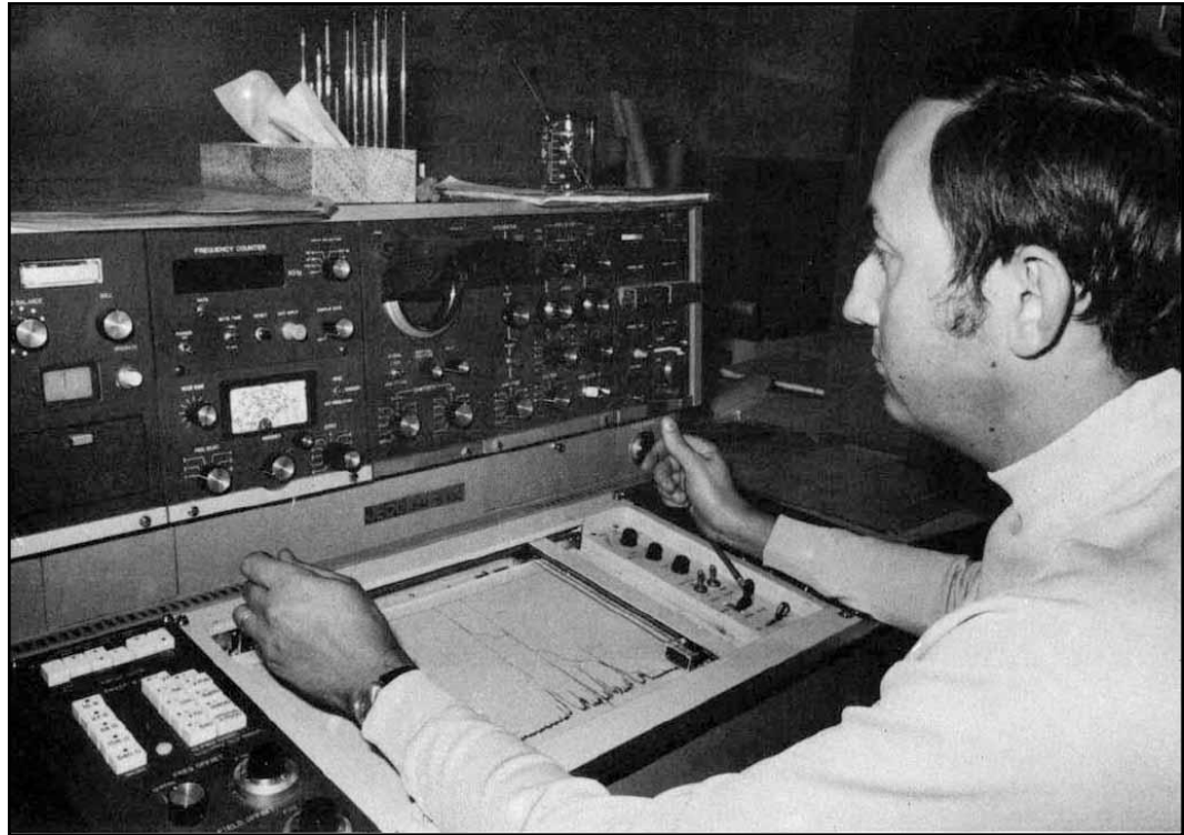
Figure 8. Le biochimiste à la fenêtre d'un spectromètre à résonance nucléaire vérifiant la pureté d'un échantillon.
