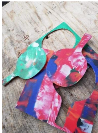
Figure 9 (à droite) : Plaque de déchets plastiques recompressés à chaud, essai pour des raquettes de Ping-pong, La Louvière, 2019. ©L'OCCAUX21 UMONS - Recycl'lab.
